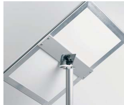
Sternmutter lösen, Rahmen drehen, einrasten, Sternmutter festdrehen – fertig.
