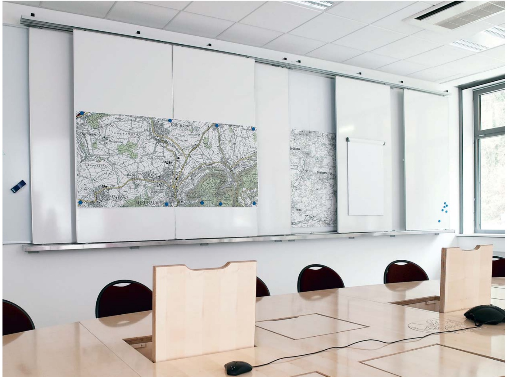
2 Lagezentrum eines Krisenstabes. Leichtgängige Rollapparate oben und kugelgelagerte Führungsrollen unten lassen die Tafeln ohne Kraftaufwand in der Anlage schweben.
