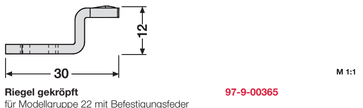
Riegel gekröpft für „Schwere Baureihe“ mit Befestigungsfeder (auch 3-Punkt-Verriegelung „Schwere Baureihe“)
